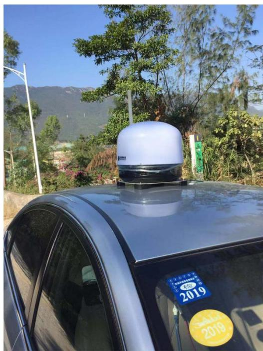
前端车载动中通移动发射
